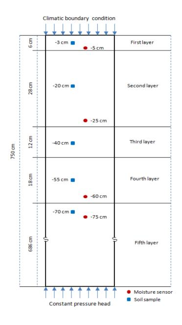
Figure 6.7. Model Used in SVFLUX.
